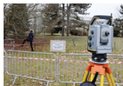
Topographie fine de la surface du sol sur un affaissement en cours de formation, en vue de mesures géophysiques en microgravimétrie © BRGM - Gisele Nour
